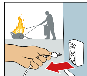
Brand i elektrisk utrustning. Dra ur kontakten innan du försöker släcka. Har du en pulversläckare kan du släcka direkt.
